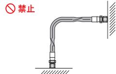
4. 请保护TOYOX扣压品免受外伤。TOYOX扣压品有可能与其他物体(机械、设备等)接触时，可能会因外伤而导致胶管破裂或接头损伤。
